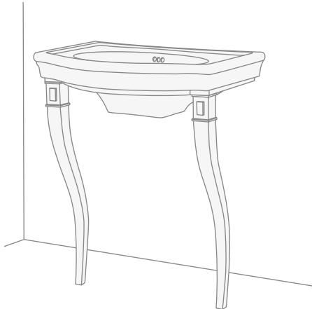
**12)** Заделайте силиконовым герметиком стык между раковиной и стеной.
