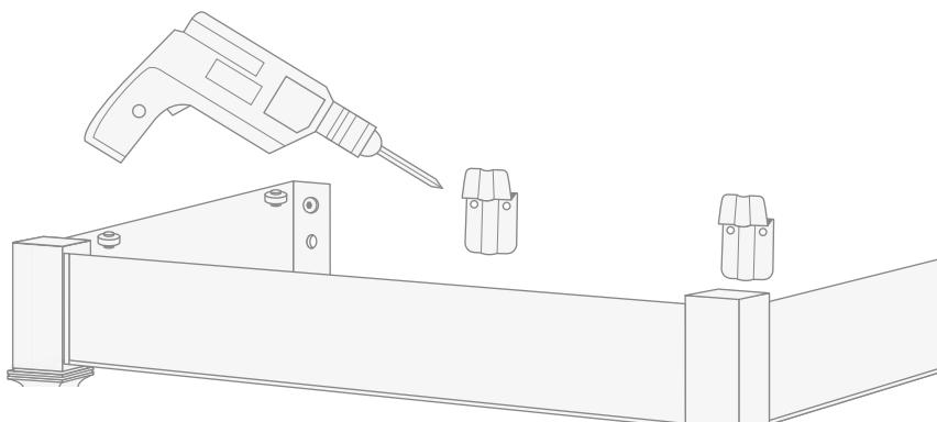
*Die S-Bügel nun anbringen mit Hilfe von Schrauben und Dübeln, die nicht Teil der Lieferung sind.*
