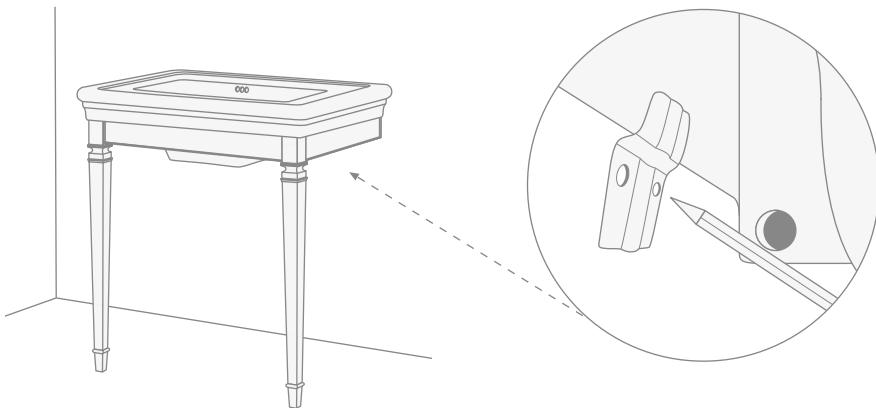
**12)** Теперь можно снять раковину и просверлить отверстия в стене согласно сделанным отметкам.
