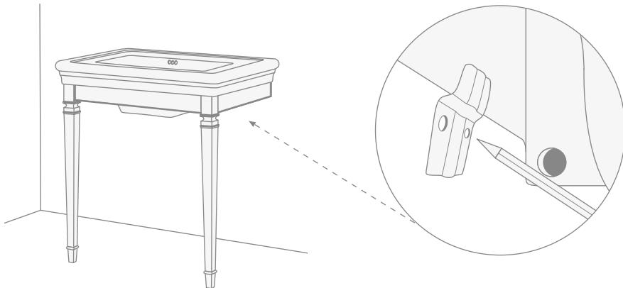
**12)** A ce point, il est possible d'enlever le lavabo et de réaliser les trous, en respectant les traçages.
