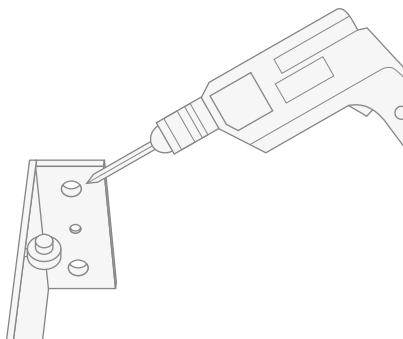
*Die nicht mitgelieferten Dübel in die Löcher einsetzen, die Trägerkonstruktion wieder positionieren und mit den nicht mitgelieferten Schrauben befestigen.*
