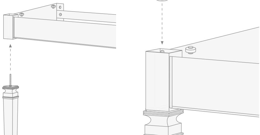
**4)** Завинтите шайбу и затяните ее так, чтобы ножка была крепко фиксирована на конструкции.
