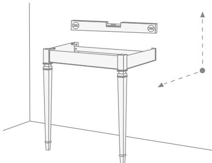
Vérifiez le positionnement de la structure à l'aide d'un niveau en direction tant parallèle que perpendiculaire au mur.
