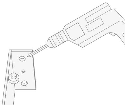
*Inserire i tasselli non forniti nei fori, posizionare di nuovo la struttura e fissarla con le viti anch'esse non fornite.*
