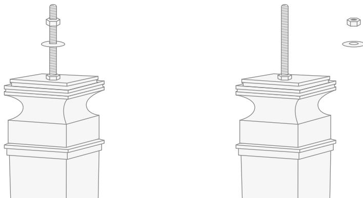
**2)** Introduzca la pata en la estructura de metal.
