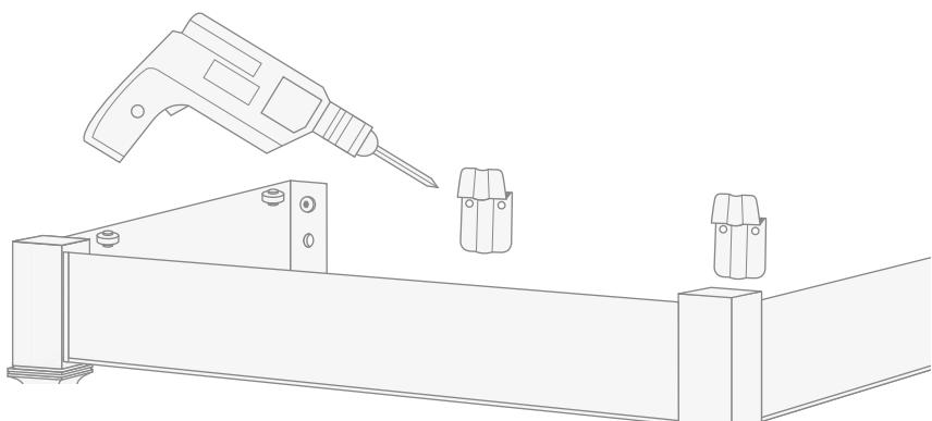
Установить скобы для опоры раковины, зафиксировав их при помощи дюбелей и винтов (не входят в комплект мебели).
