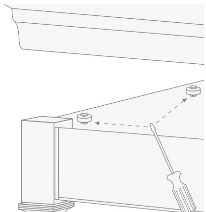
*Si es necesario, intervenga en los soportes ajustables, utilizando el destornillador plano.*
