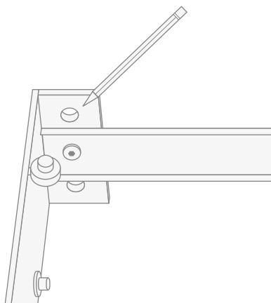
**7)** A l'aide de la clé à six pans démontez la barre d'écartement située sur la partie arrière de la structure, dévissant les deux vis.
