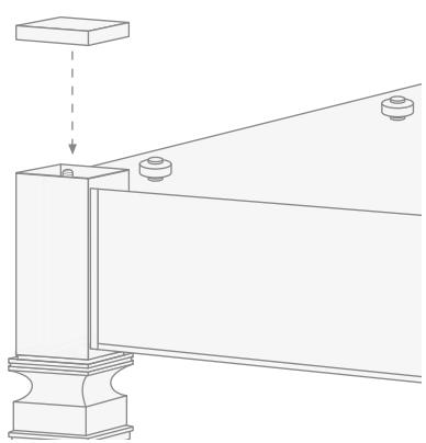
**10)** Appuyez le lavabo Etoile sur la structure, cherchant un compromis entre l'appui sur la structure et l'appui sur le mur.
