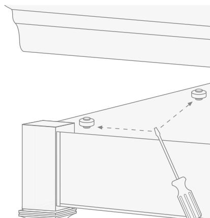
При необходимости отрегулировать опоры при помощи прямошлицевой отвертки.
