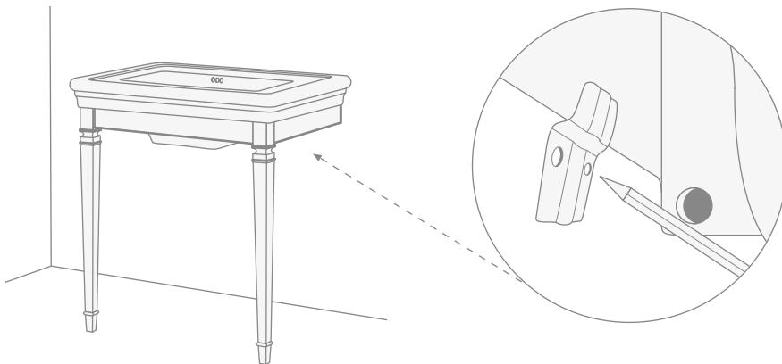
**12)** A questo punto è possibile rimuovere il lavabo ed eseguire le forature a muro, rispettando le tracciate.
