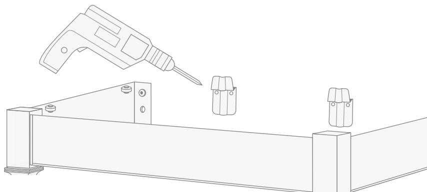
*Montare le staffe di supporto del lavabo, fissandole con viti e tasselli (non forniti in dotazione).*
