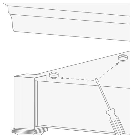
*Falls erforderlich, die regelbaren Stützen mit dem Schlitzschraubendreher einstellen.*
