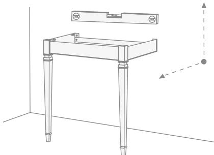
Проверить уровень ее параллельное и ортогональное положение по отношению к стене.
