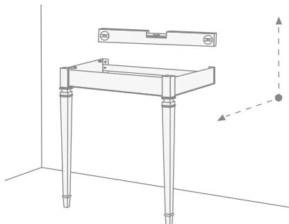
*Verificare il posizionamento della struttura tramite una livella in direzione sia parallela che ortogonale a muro.*
