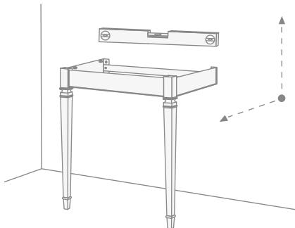
*Compruebe la posición de la estructura utilizando un nivel en dirección paralela y ortogonal respecto a la pared.*
