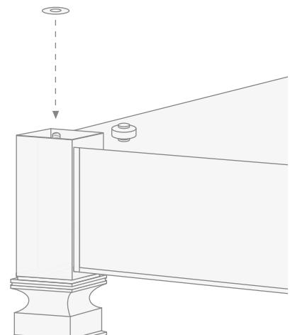
**4)** Vissez l'écrou et serrez jusqu'à bloquer rigidement la patte sur la structure.
