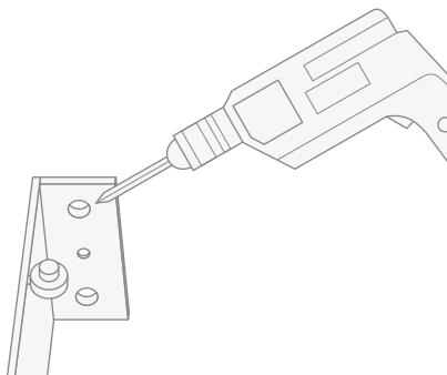
*Inroduzca los tacos en los agujeros, coloque otra vez la estructura y fíjela con los tornillos (tacos y tornillos no proporcionados por Devon&Devon).*
