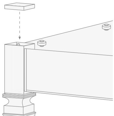
**10)** Apoye en la estructura el lavabo Étoile, comprobando que quede bien colocado, tanto en la estructura, como en la pared.
