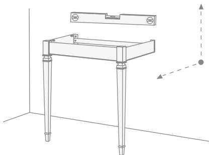
*Ihre Lage mit der Wasserwaage parallel und im rechten Winkel zur Wand prüfen.*
