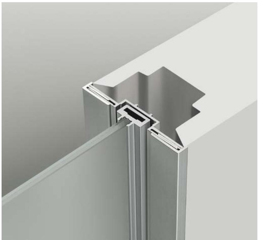
La porta Vela con sistema di chiusura magnetica a scomparsa è dotato di un profilo di battuta in gomma siliconica, che assicura silenziosità e affidabilità nel tempo. La versione con serratura magnetica presenta uno stipite telescopico in alluminio anodizzato o verniciato che permette di compensare lo spessore di eventuali rivestimenti. Caratteristica della porta scorrevole è invece lo stipite telescopico ultrasottile con montaggio ad incastro senza viti e guarnizioni a vista.
