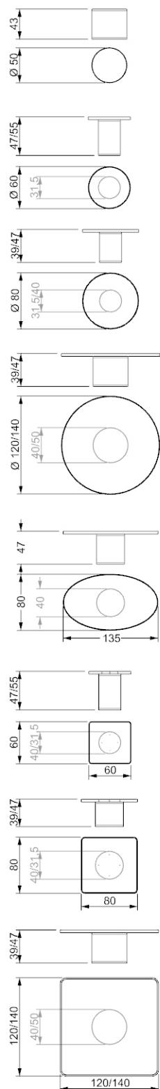
Tavolini con basamento a cilindro in finitura satinata: ottone (104M), ottone dark (105M), titanio (101M), titanium dark (102M). Piano in legno sp.40mm in tinta con il cilindro.
