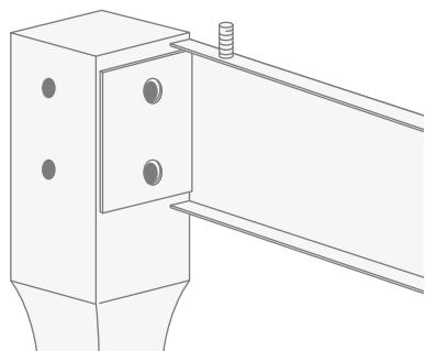
**3)** Fixer les bandes latérales aux pattes au moyen des vis à six pans et des rondelles fournies. Veuillez remarquer que les vis de réglage pour le lavabo présentes sur les bandes latérales sont orientées vers le haut.
