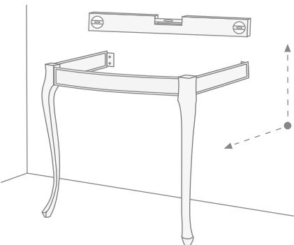
Die Lage der Struktur mit einer Wasserwaage parallel und senkrecht zur Wand prüfen.
