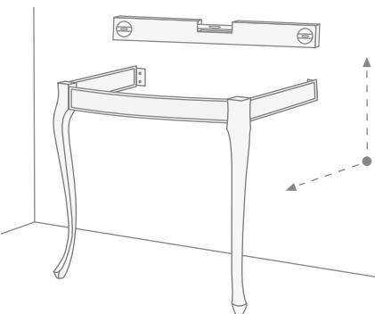
Vérifier le positionnement de la structure à l'aide d'un niveau en direction parallèle et perpendiculaire au mur.
