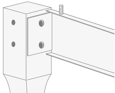
**3)** Die Seitenteile mit den mitgelieferten Inbusschrauben und Unterlegscheiben an den Beinen befestigen. Dabei ist darauf zu achten, dass die an den Seitenteilen vorhandenen Schrauben zur Regelung des Waschbeckens nach oben gerichtet sein müssen.
