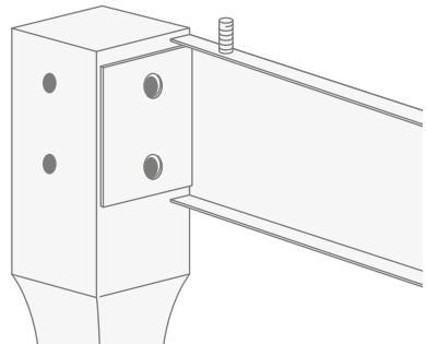
**3)** Fissare le fasce laterali alle gambe tramite le viti a brugola e le rondelle in dotazione. Notate che le viti di regolaggio per il lavabo presenti sulle fasce laterali devono essere rivolte verso l'alto.
