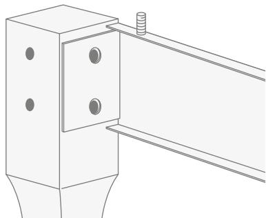
**3)** Fije las fajas laterales en las patas utilizando los tornillos Allen y las arandelas que se proporcionan en dotación. Nótese que los tornillos de regulación del lavabo, presentes en las fajas laterales han de estar dirigidos hacia arriba.
