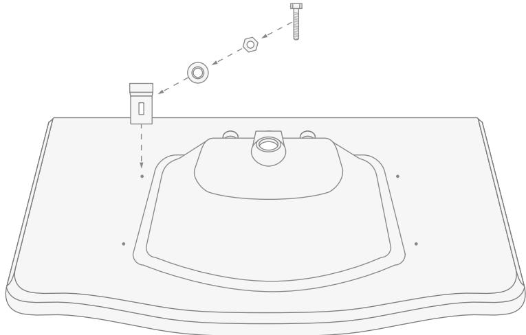
**11)** Die 4 Schrauben und die 4 Muttern festziehen und dadurch das Waschbecken auf der Marmorabdeckplatte sichern.
