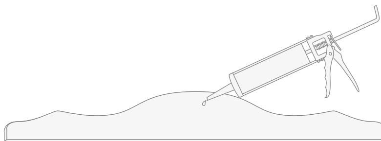
**15)** Montare l'alzatina sul top in maniera che il suo lato posteriore appoggi a muro e sia centrata rispetto al top. Per evitare possibili errori di posizionamento, potete fare una prova "a secco" tracciando la posizione dell'alzatina prima di applicare il silicone.
