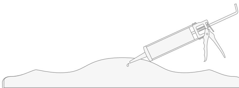
**15)** Monter la rehausse sur le dessus de façon à ce que son côté arrière soit adossé au mur et qu'elle soit centrée par rapport au dessus. Pour éviter les erreurs de positionnement, vous pouvez faire un essai “à sec” en traçant la position de la rehausse avant d'appliquer la silicone.
