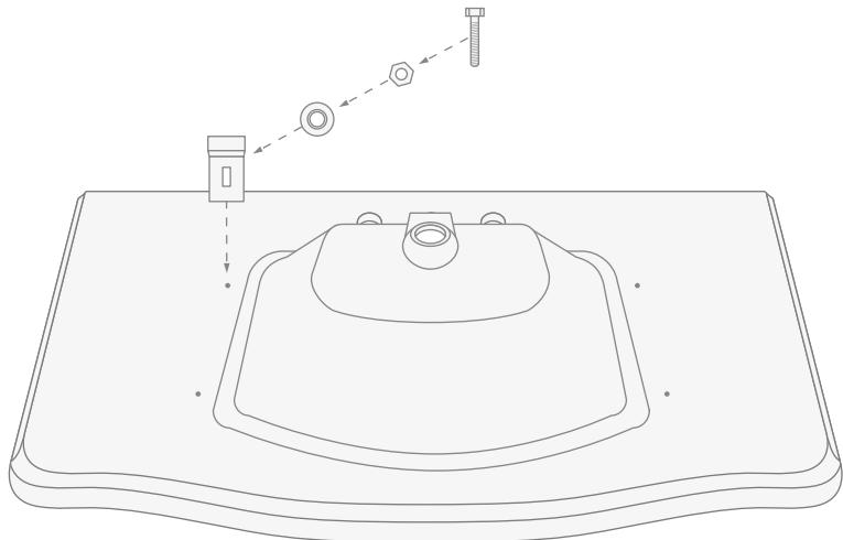
**11)** Serrer les 4 vis et les 4 écrous en bloquant le lavabo sur le dessus en marbre.
