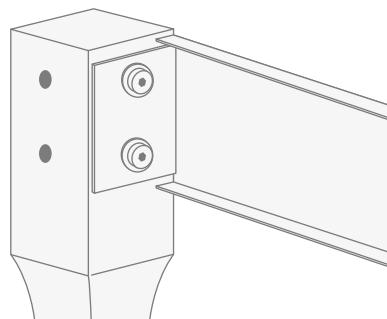
**4)** Après avoir monté une bande latérale sur chaque patte, joindre les pattes au moyen de la bande frontale (qui a les deux extrémités identiques). La fixation de la bande frontale aux pattes s'effectue de la même façon que celle des pattes latérales.
