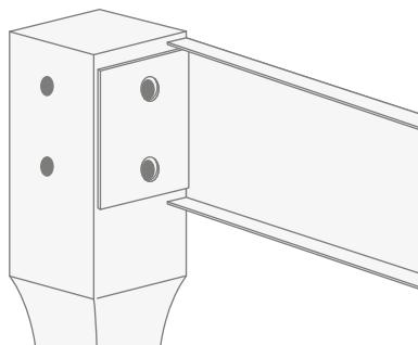
**3)** Fije las fajas laterales en las patas utilizando los tornillos Allen y las arandelas proporcionados en dotación.
