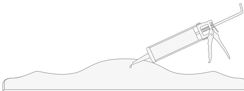
**15)** Monte el bordillo en la encimera, de manera que su lado trasero quede apoyado en la pared y que el bordillo quede centrado respecto a la encimera. Para evitar posibles errores de colocación, puede hacer una prueba “en seco”, marcando la posición del bordillo antes de aplicar la silicona.
