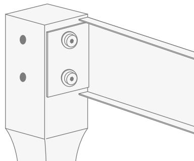
**4)** Una volta montata una fascia laterale su ciascuna gamba, unire le gambe tramite la fascia frontale (che ha le due estremità uguali). Il fissaggio della fascia frontale alle gambe si effettua allo stesso modo di quelle laterali.
