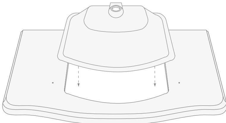
**10)** Закрепить раковину при помощи кронштейнов и соответствующих винтов, шайб и гаек.
