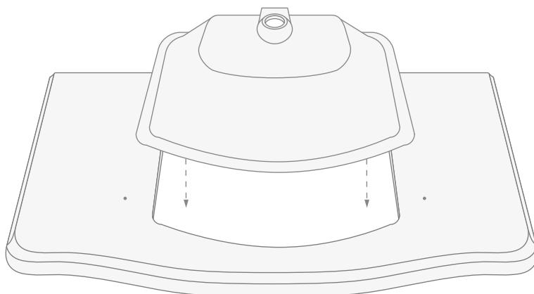
**10)** Die Befestigungsbügel montieren und mit den Schrauben, Unterlegscheiben und Muttern befestigen.
