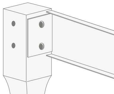
**3)** Fissare le fasce laterali alle gambe tramite le viti a brugola e le rondelle in dotazione.
