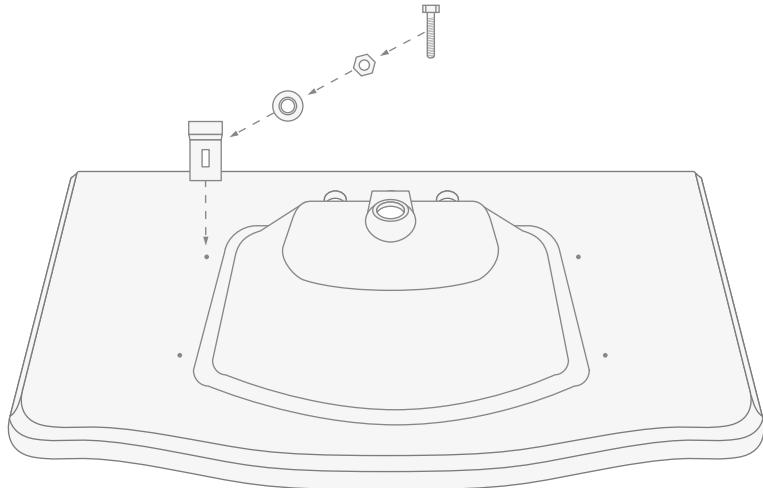
**11)** Затянуть 4 винта и 4 гайки, чтобы зафиксировать раковину на мраморной столешнице.
