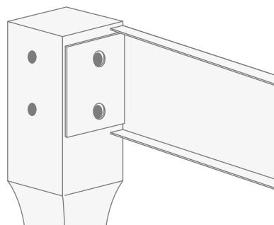
**3)** Fixer les bandes latérales aux pattes au moyen des vis à six pans et des rondelles fournies.
