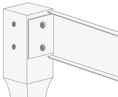
**3)** Befestigen Sie die Seitenteile mit den mitgelieferten Inbusschrauben und Unterlegscheiben an den Beinen.
