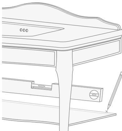
**14)** Rimuovere la mensola, eseguire le forature per i supporti a muro e montare i supporti con le viti di bloccaggio rivolte verso il basso.
