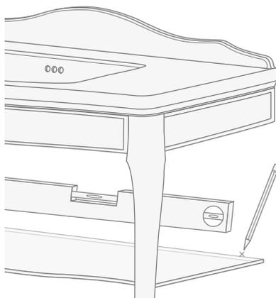
**14)** Retirer la console, réaliser les trous pour les supports au mur et monter les supports au moyen des vis de blocage orientées vers le bas.
