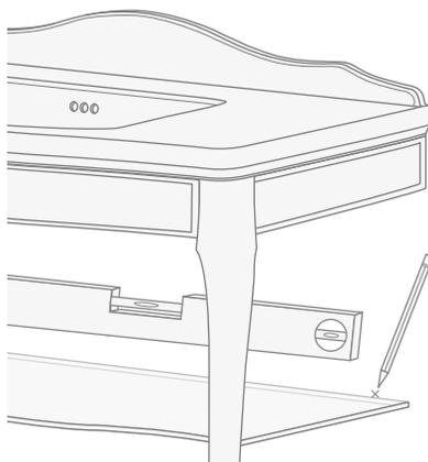
**14)** Die Ablage entfernen, die Bohrungen für die Halter der Ablage ausführen und die Halter mit nach unten gerichteten Befestigungsschrauben montieren.
