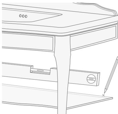
**14)** Снимите полку, просверлите отверстия в стене, вставьте кронштейны таким образом, чтобы крепежные винты были направлены вниз.
